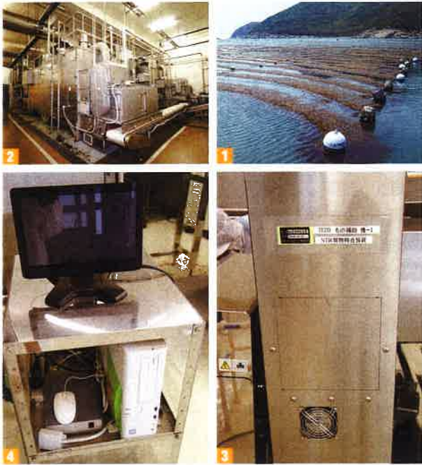
1 栽培契約を結んでいる韓国・莞島付近のひじき養殖場。厳しい品質管理は養殖場から始まっている／2 独自技術が投入されている調味加工工程。原藻の状態を見極めながら細かい調整が行われている／3,4 シーウィード・ジャパンに導入されたNIR異物検査装置。右写真はNIRライン照明、NIR 3波長ラインセンサーカメラ、可視光センサーカメラなどを収めたユニット。開発当初と比べて非常にコンパクトなユニットになった。左写真は制御用パソコン
